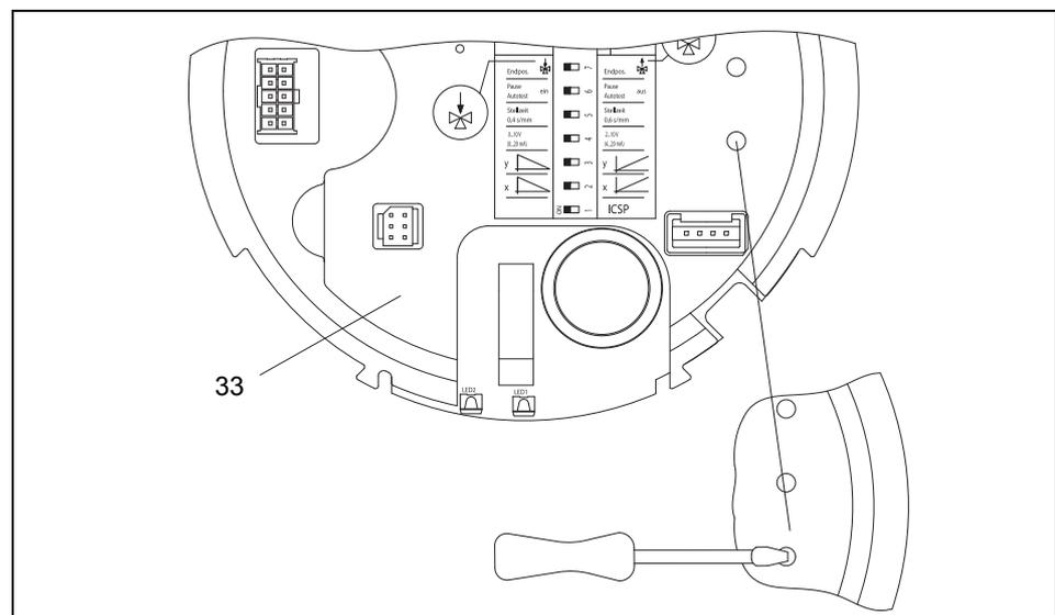
**Bild 10** Platinenabdeckung im Antriebsgehäuse abnehmen
