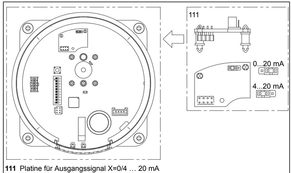
**Bild 2** Platine für mA-Ausgangssignal auf der Hauptplatine
