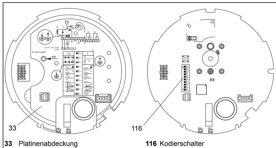
**Bild 15** Platinenabdeckung und Kodierschalter
