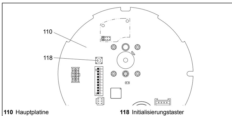
**Bild 20** Wegmesssystem initialisieren
