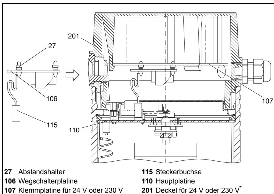
**Bild 11** Einbau der Wegschalterplatine im Deckel
