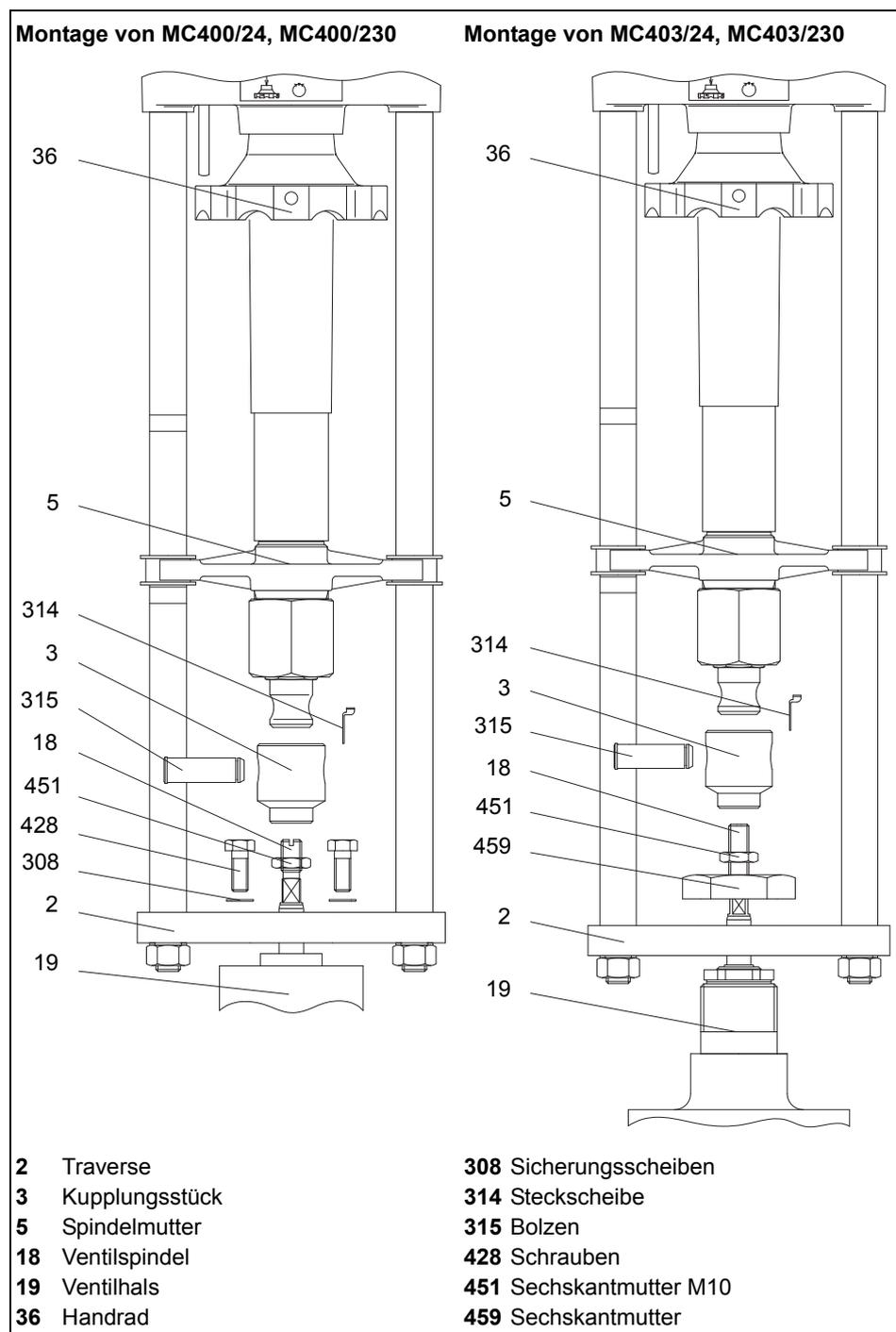
**Bild 6** Hubantrieb auf Ventil montieren
