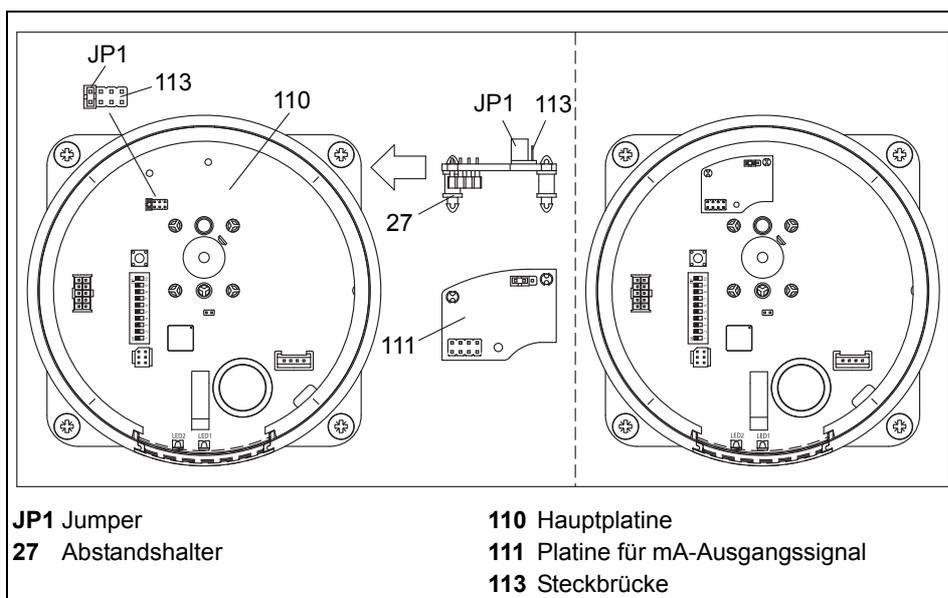
**Bild 13** Einbau der Platine für mA-Ausgangssignal
