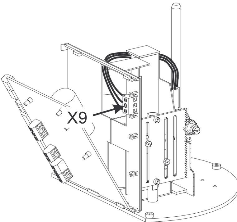
Klemmleiste X9 einsetzen
