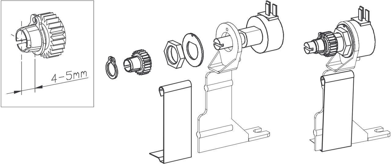
Einbau des Potentiometers
