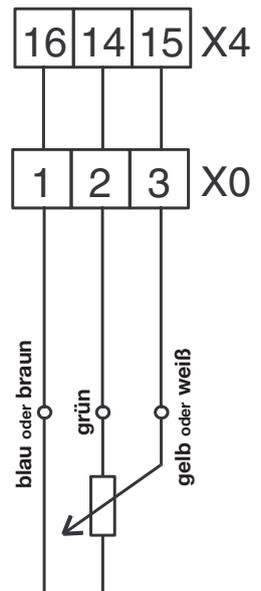
Anschluss an Klemmleiste X0
