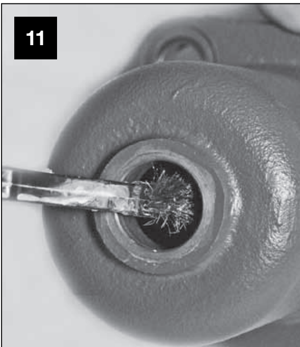
Die Hauben-Dichtung entfernen und säubern.
