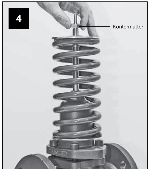
Die Kontermutter lose auf die Kegelstange schrauben.
