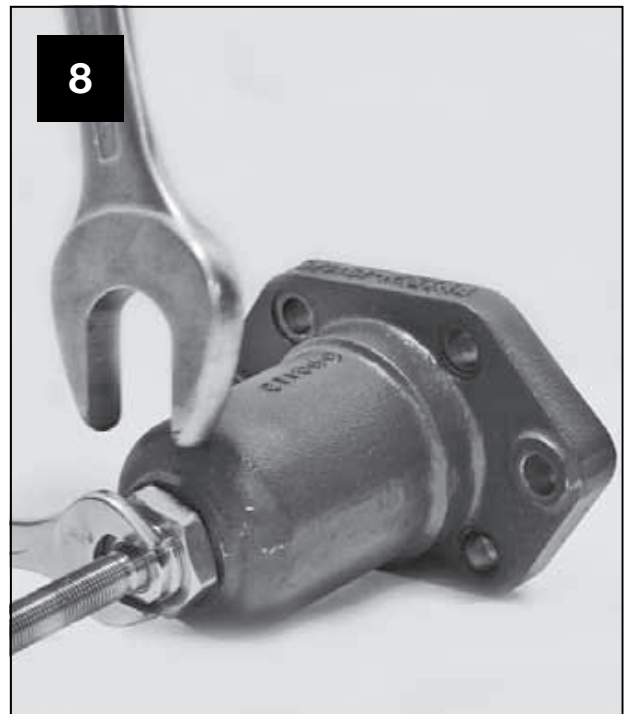
Mit einem 24-er Schlüssel die beiden flachen Seiten am Faltenbalg halten und die Befestigungsmutter mit einem 36-er Schlüssel lösen.
