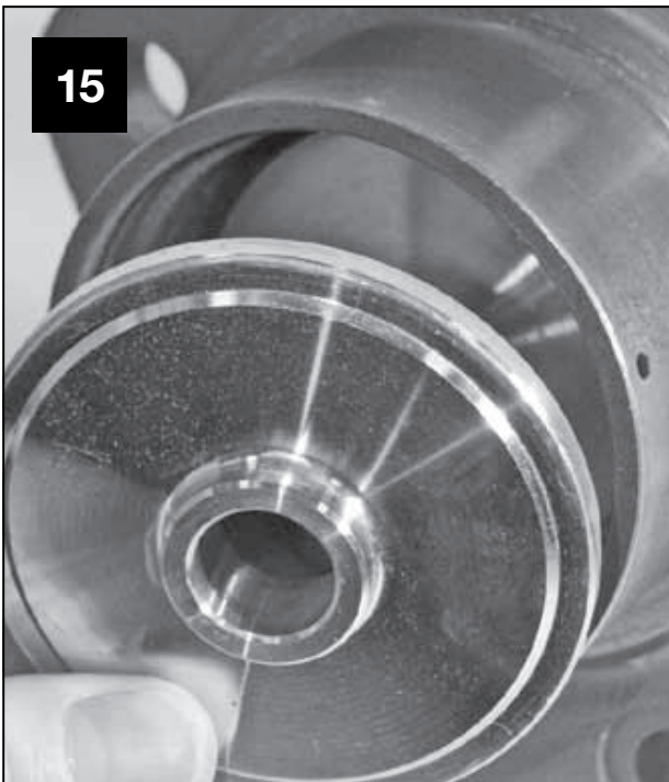
Die Kegelstangen-Führungsplatte und den Schnapping befestigen (nur bei DN 65-DN 100).
