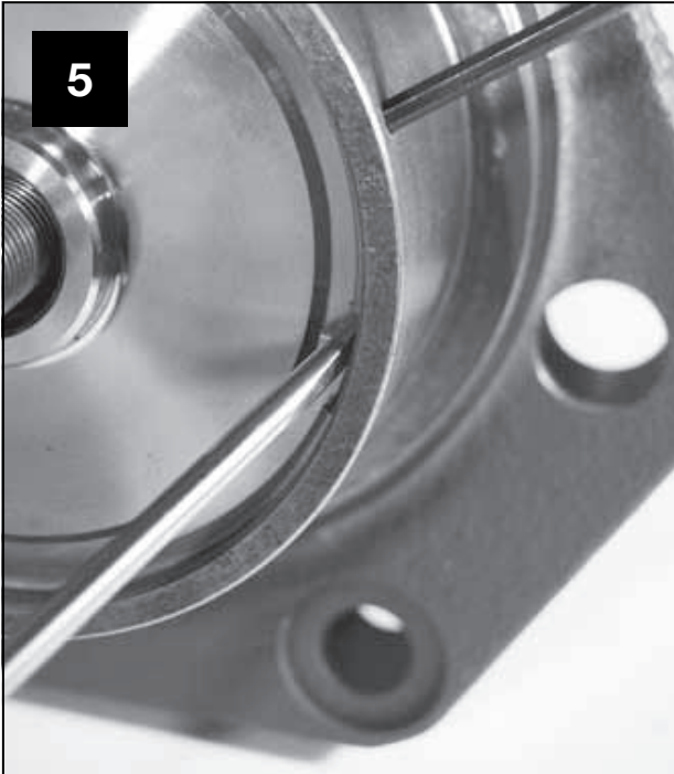
Das kleine Loch suchen und den Schnapping halten (nur bei DN 65-DN 100).
