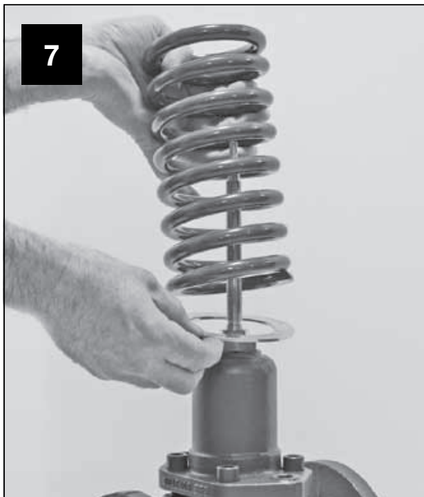
Die Feder (11) und die Federplatte entfernen.
