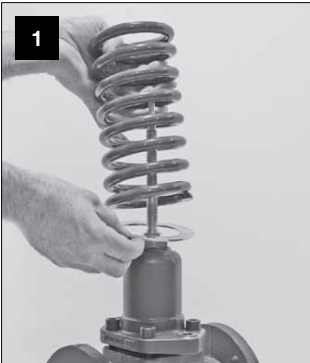
Die Federplatte und die Feder montieren.
