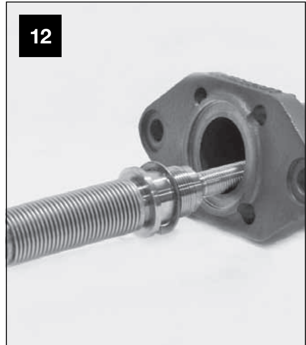
Eine neue Dichtung über die neue Kegelstange stecken.
