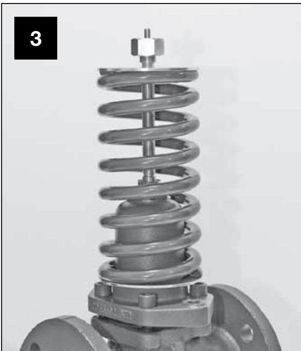
Die Sollwert-Feststellmutter ca. 20 mm nach unten drehen.
