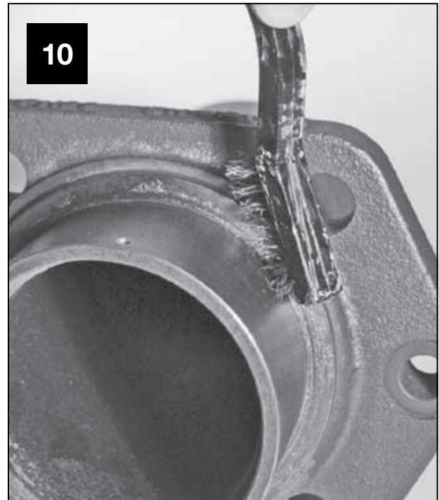
Die Faltenbalg-Dichtungen entfernen und säubern.
