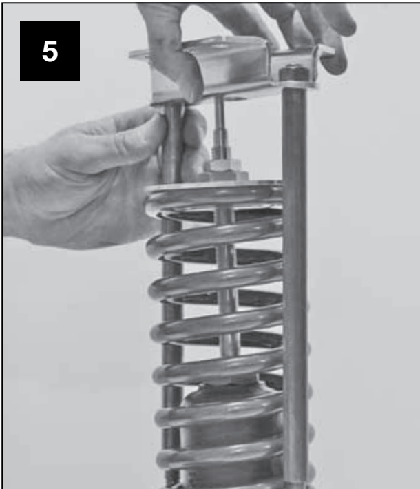
Den Antrieb auf die Laternenstangen stecken.
