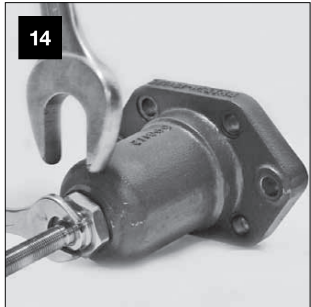
Die Befestigungsmutter auf die Kegelstange drehen. Mit einem 24-er Schlüssel die beiden flachen Seiten am Faltenbalg halten und die Befestigungsmutter mit einem 36-er Schlüssel mit 60-65 Nm festdrehen.
