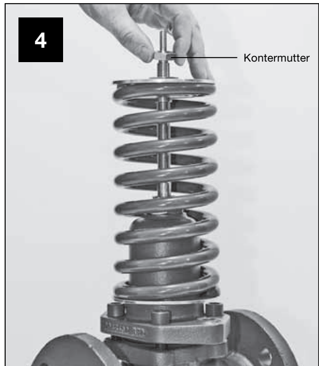
Die Kontermutter lose auf die Kegelstange schrauben.
