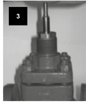
Kegelstange voll ausfahren.
