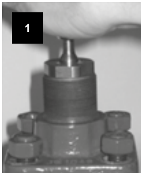
Gehäusemuttern (9) lose anschrauben.
