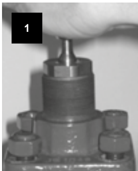
Gehäusemuttern (9) lose anschrauben.
