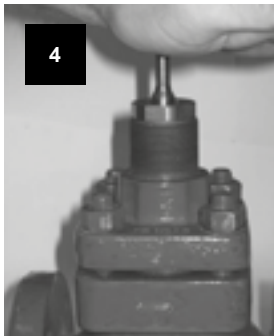
Kegelstange fest und schnell nach unten drücken.
