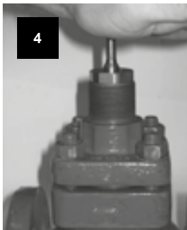
Kegelstange fest und schnell nach unten drücken.
