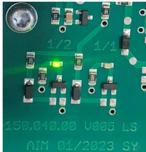
Wenn keine LEDs leuchten, sind die Superkondensatoren zu weniger als 50 % geladen. Weniger als 50 % sind weniger als 10,3 V
