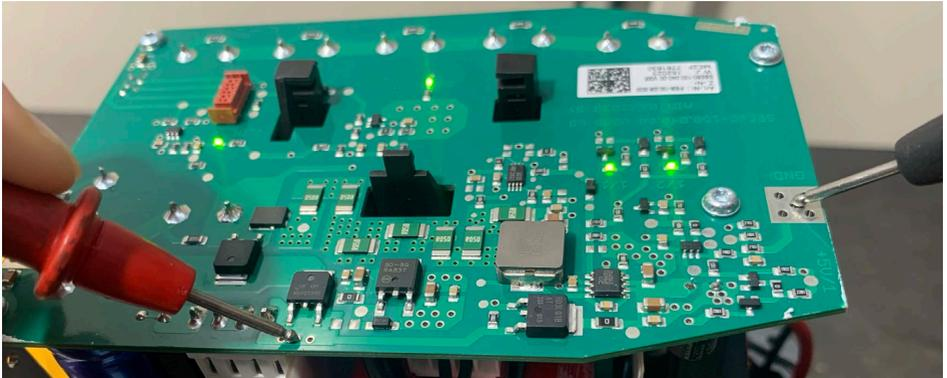
**Hinweis**, die gemessene Spannung ist Gleichspannung. Bei Verwendung von 24 Vac als Eingangsstromversorgung beträgt die gemessene Spannung etwa 33,8 Vdc.
