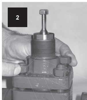
Utáhněte prsty rovnoměrně vždy pár protilehlých matic nebo šroubů.
