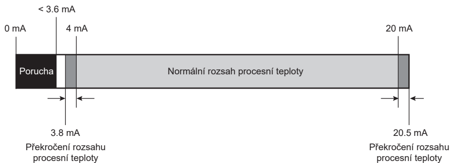
Obr. 6 Signál vysílače 4 - 20 mA (standardizováno dle NAMUR NE43)
