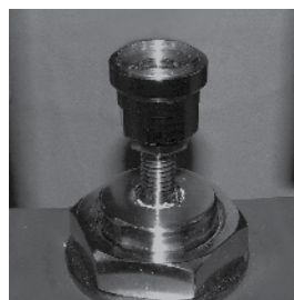
Obr. 17 Správně - 8 mm závitu natočeno
