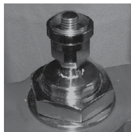
Obr. 18 Nesprávně - závit vyčnívá nad adaptérem
