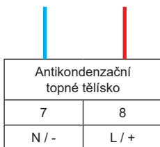
Obr. 23 Zapojení svorek antikondenzačního topného tělíska
