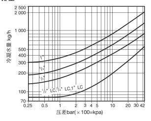
在选择TD42S3时必须选择正确的型号,以确保工作正常并获得最长的使用寿命。对主管疏水和伴热线疏水,不论管径如何,都选择LC(低排量)型疏水阀。
