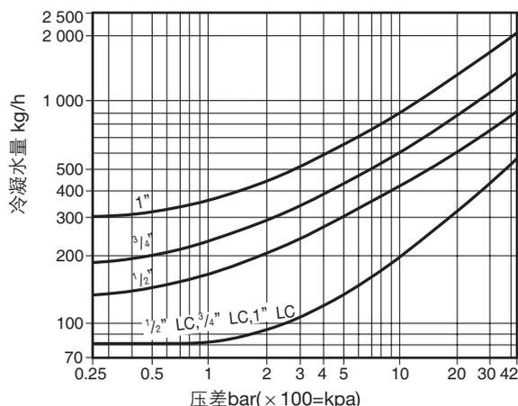
在选择TD42S2时必须选择正确的型号，以确保工作正常并获得最长的使用寿命。对主管疏水和伴热线疏水，不论管径如何，都选择LC(低排量)型疏水阀。
