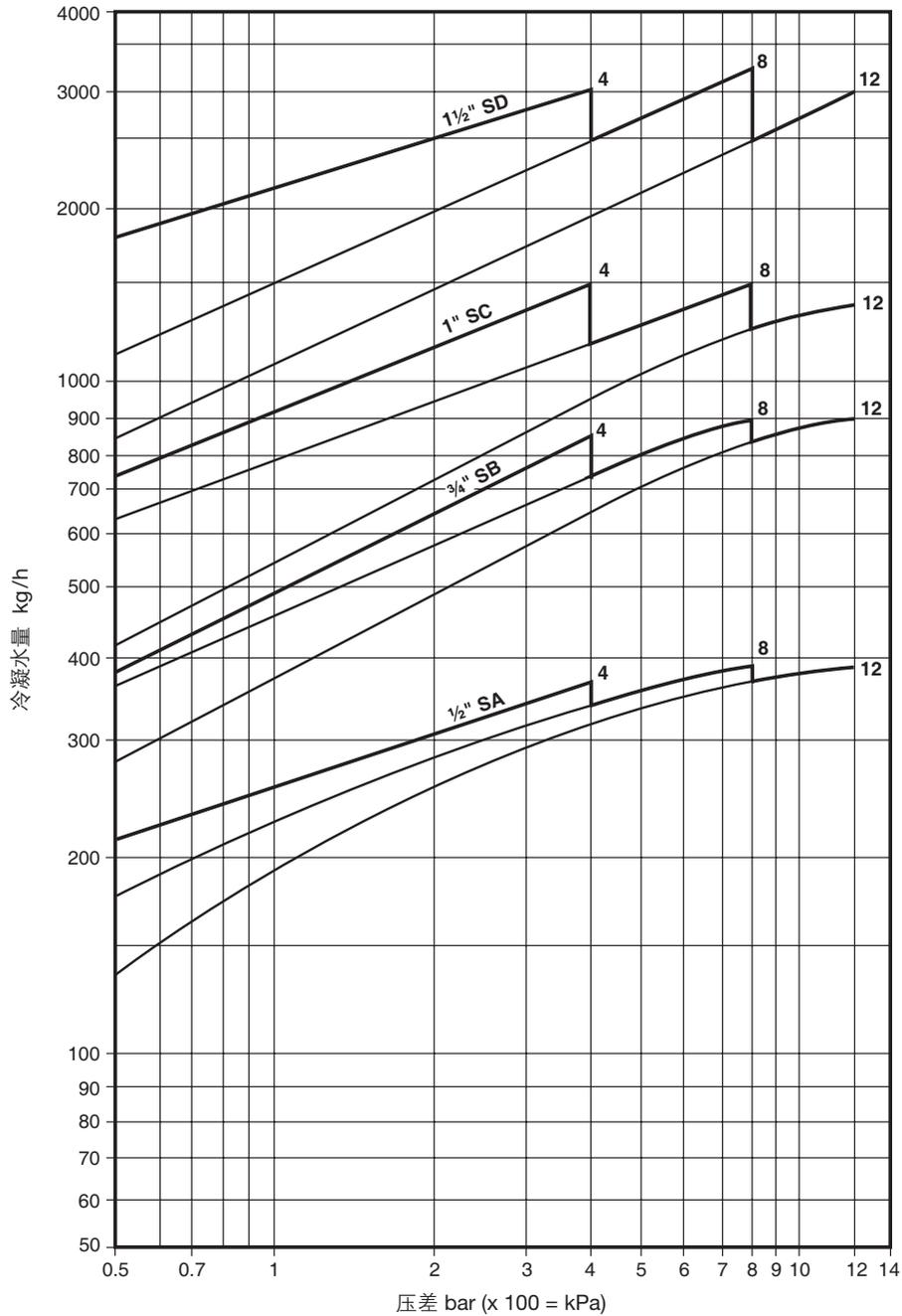
注: 疏水阀选型时应根据最合适的工作压差, 而非完全据于负荷。
