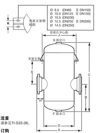
举例:斯派莎克DN80 S7碳钢材质汽水分离器,PN40法兰 连接。适用最大压力至25bar(请注明设计等级)。
