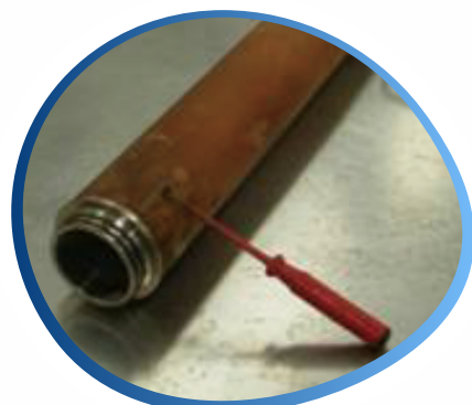
过滤蒸汽使用一段时间滤芯表面很脏
