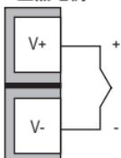
使用正确的补偿电缆（屏蔽型更好）
