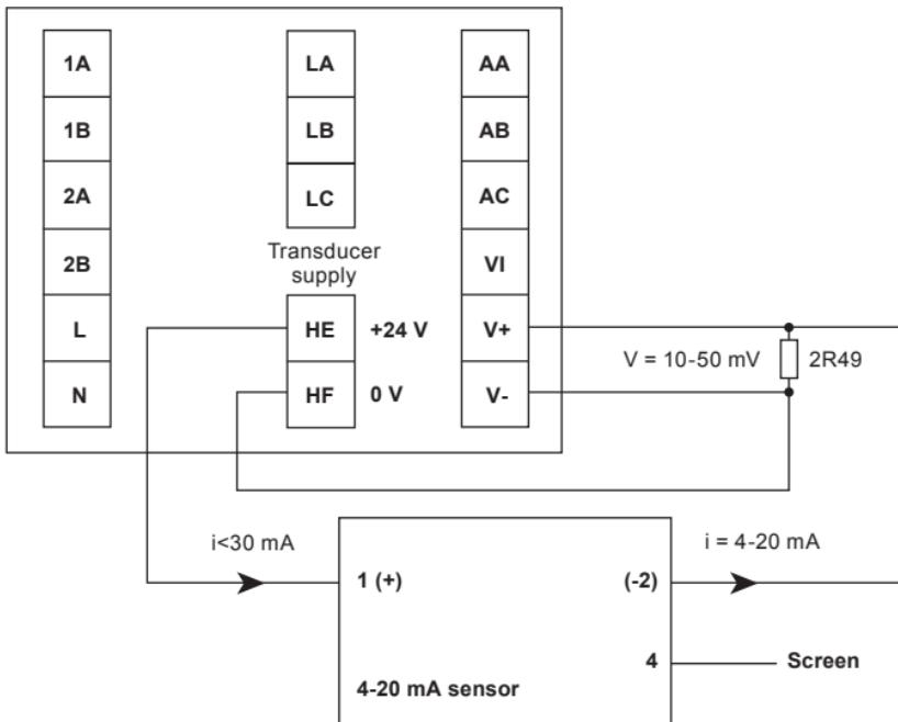
SX90连接变送器接线图
