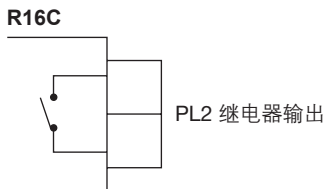
图16 一个或多个疏水阀故障，或电源断掉。
