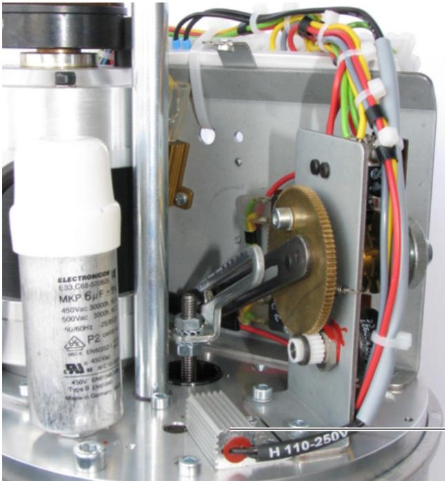
图22. 安装防冷凝加热器 ( 8 - 20 KN )
