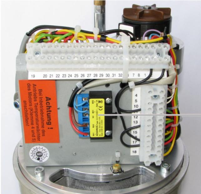
防冷凝加热器端子板
