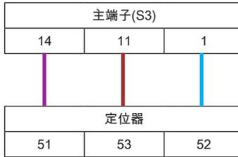
图27. 定位器安装端子图 ( 8 kN+ )
