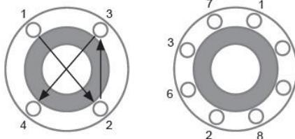
Parafusos do flange devem ser gradualmente apertados em diâmetros transversais para assegurar mesma carga e alinhamento.
